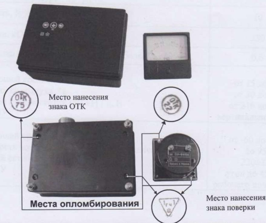
Рисунок 1 - Общий вид приборов, схема пломбировки от несанкционированного доступа и обозначение мест нанесения знака поверки и знака ОТК
