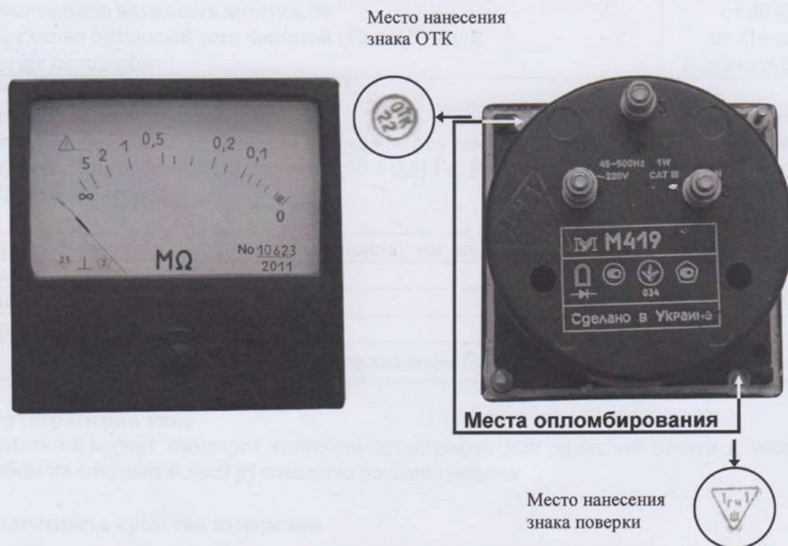
Рисунок 1 - Общий вид омметров, схема пломбировки от несанкционированного доступа и обозначение мест нанесения знака поверки и знака ОТК
